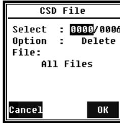
Menü von **CSD Datei** kann die CSD-Datei anzeigen, drucken und löschen. Drücke <▲>, <▼> um den Cursor Zwischen **Select** Und **Option** zu wechseln. Löschvorgang ist identisch mit
