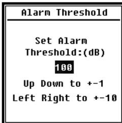
Wenn das Messergebnis von Profil 1 bis 3 die **Alarmschwelle** überschreitet, wird die LED-Anzeige über **<Power>** rot. Die Alarmschwelle kann auf 20dB-200dB eingestellt werden. Drücken Sie <▲>, <▼>, um 1 dB zu erhöhen und zu verringern. Drücken Sie <◀>, <▶>, um 10 dB zu erhöhen und zu verringern.
