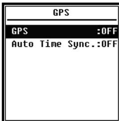
Menü von **GPS** kann das **GPS** und **Auto Time Sync** on-off einstellen. Wenn GPS ausgeschaltet ist, wird das interne GPS-Modul heruntergefahren. Wenn Sie **Auto Time Sync** aktivieren, wird die RTC des Schallpegelmessers synchronisiert, wenn sie die GPS-Zeit erhält und einmal pro Stunde synchronisiert.
